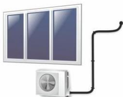
Правильно закреплённая трасса обеспечивает надёжное соединение медных трубок фреоноводов с наружным блоком кондиционера
