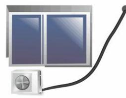
Неправильно смонтированная трасса раскачивается от ветра и в месте соединения с наружным блоком в медных трубках образуются трещины
